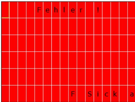
Das Überwachungsfeld 2 des SICK Laserscanners an der unteren Haltestelle ist nicht frei. Ein oder mehrere Objekte werden vom Laserscanner erkannt.
