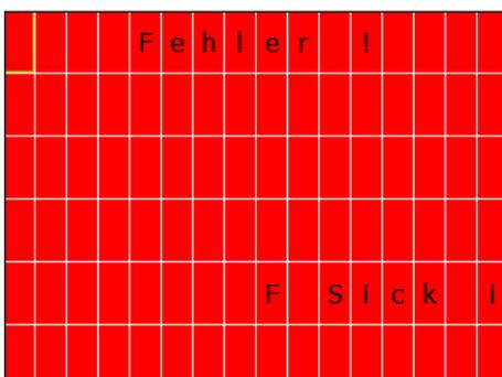
Das Überwachungsfeld 1 des SICK Laserscanners an der unteren Haltestelle ist nicht frei. Ein oder mehrere Objekte werden vom Laserscanner erkannt.
